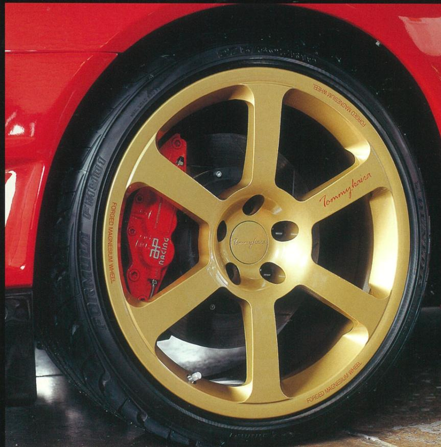
GT-Rクラスのマシンをレーシングスピードで操るには、サスペンションの一部であるホイールが重要なチューニングパーツとなります。トミーカイラRの開発と同時にスタートした専用ホイール。トミーカイラ「PRO R」は、あのF-1マシンに装着されているレーシングホイールと同じ素材、同じ製法でつくられた超軽量ホイールです。パネ下重量の軽量化によって実現したトミーカイラRのシャープなハンドリングには、このトミーカイラ「PRO R」の存在があります。
