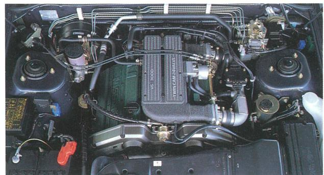
●VG30DET(V型6気筒)にトミーカイラチューニングを施したうえに、さらにターボも換装。280ps/6200rpmを樂々絞り出す。
