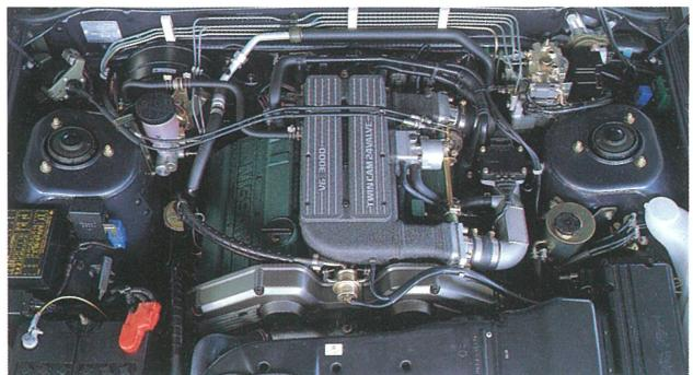
●VG30DET(V型6気筒)にトミーカイラチューニングを施したうえに、さらにターボも換装。280ps/6200rpmを楽々絞り出す。トミーカイラグレーに塗装されたヘッドカバーがその証となる。
