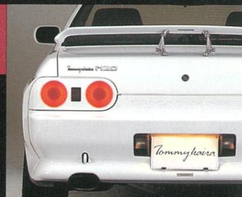
をすっきりと収める。リアのウイングは「テールフィン」と呼ばれる角度調整式。で、レーシングカーのウイングやサスペンションの調整に利用されるピロボールを介してトランク上に装着される。フロントもアルミのステーによって装着する。今回のエアロパーツのコンセプトのひとつに、冷却効果がある。ダウンフォースのみを追求するのではなく、空気をエンジンルームやブレーキ、タイヤに有効に導いている。
