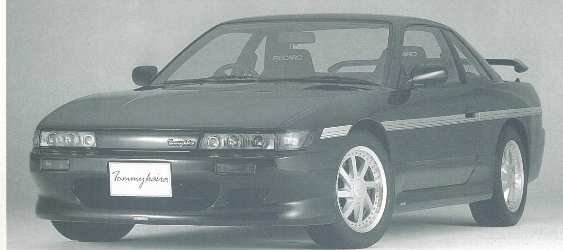
つぎつぎとFF化していく中で、毅然とオーソドックスなFRレイアウトを踏襲してきたシルビア。二代目はいよいよ待望のSR20DE(T)を搭載して、全車2000ccとなりました。我々は、初代シルビアをベースとした「トミーカイラM18Si」に引きつづいて、このSR20DE(T)を素材に、あらたに「トミーカイラM20Si」を開発。ベース車両は、基本的にエンジンのみが変更されたマイナーチェンジですが、トミーカイラではチューニングの主眼をエンジンとしながらも、総合的な見直しをはかつて、2車種4タイプ(合計8モデル)を新しくラインナップしました。
