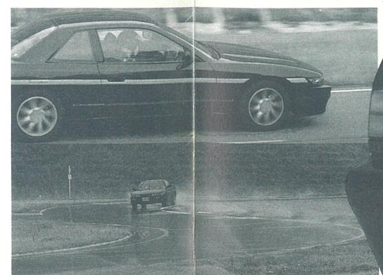
●開発時のテスト風景/(上)高速テストをするテストドライバー。耐久性、安全性などを重点的にダイヤのマッチングなどもチェックする。(下)スキッド・コースで低ミュー路における操縦安定性や、ハンドリング特性をテストする。
